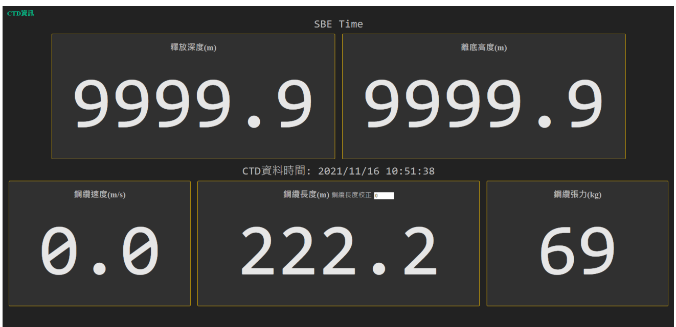
圖五、CTD 及深海絞機的鋼纜資訊畫面，9999.9 表示儀器未開。
