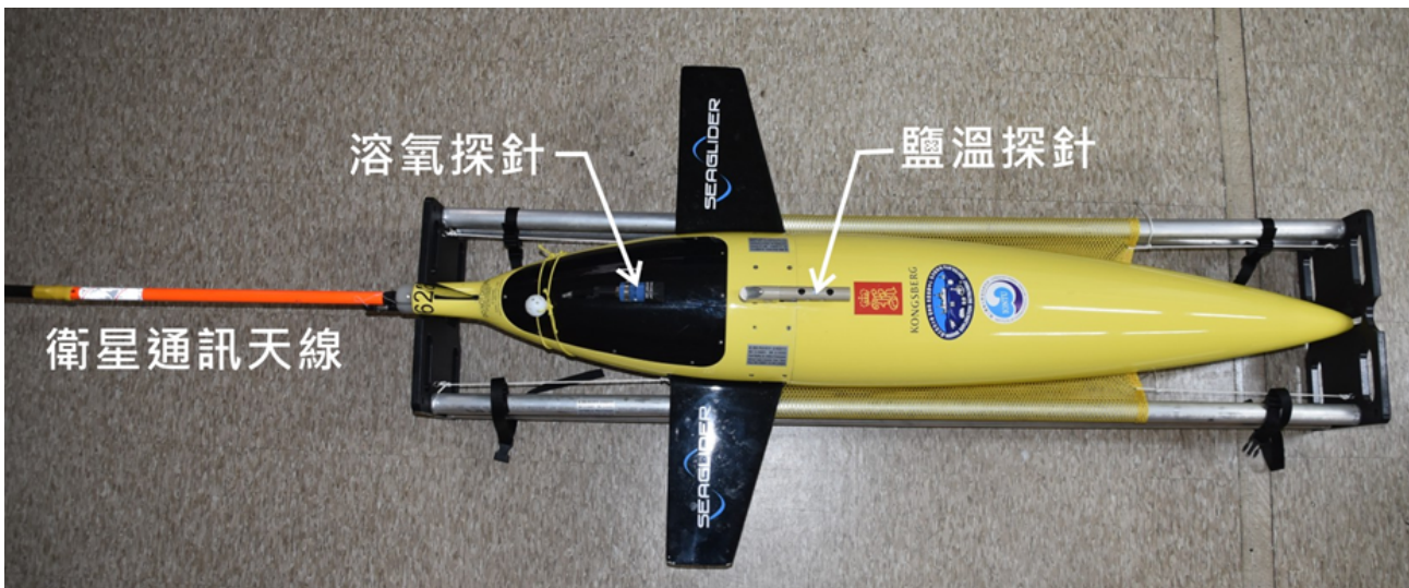
圖 1. 水下自走載具觀測儀 Seaglider，外觀似紡錘狀之流線型，機身長約為 2 公尺 (不含天線長度)，重量約 53 公斤，外殼採用可壓縮膨脹之玻璃纖維材質。
